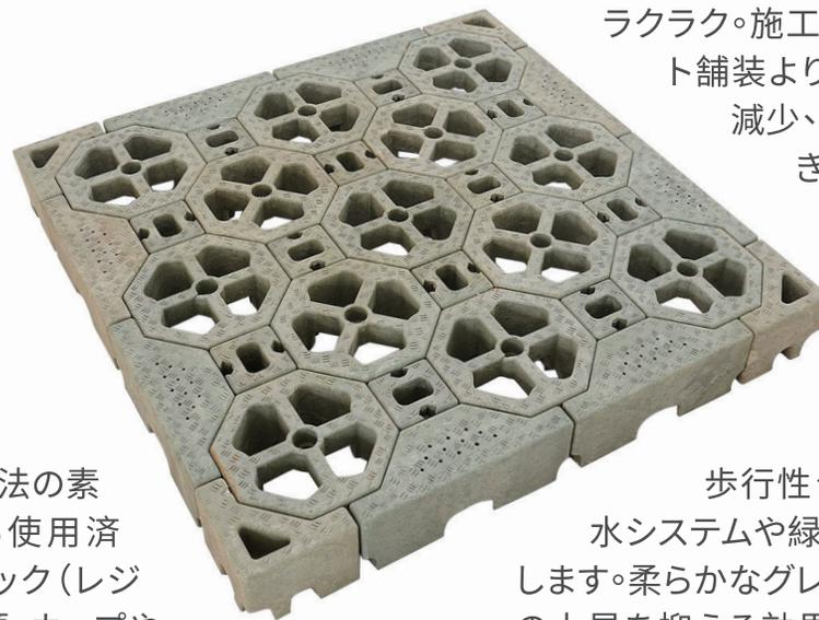
エコ・ブロックは特許インターロッキングデザインを採用することで、雨水が地面にしみ込みやすく、都市型水害や地盤沈下を緩和する効果も持ちます。軟弱地盤箇所における舗装でも、平坦性の確保に加えて、構造的強度を増やします。表面には滑りにくい加工を施しており、安全面もう一層UPします。エコ・ブロックは局部変換できますので、定期養護にもラクラク。施工工期は従来コンクリート舗装より早く、舗装路面騒音の減少、夏季の路面温度低減できます。
